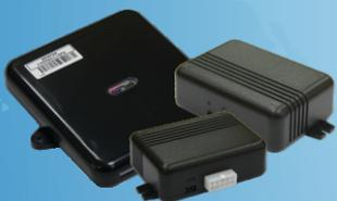
**Терминалы ADM позволяют организовать контроль ключевых показателей работы транспортного средства, осуществлять сбор данных с CAN-шины и дополнительного оборудования (датчиков уровня топлива и др.) и передавать информацию в Центр Мониторинга для ее анализа.**
