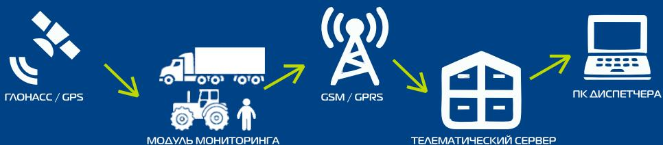
Терминалы ADM фиксируют местоположение, скорость, направление движения объекта, а также ряд других параметров, и передают информацию в Центр Мониторинга для ее дальнейшего анализа.
