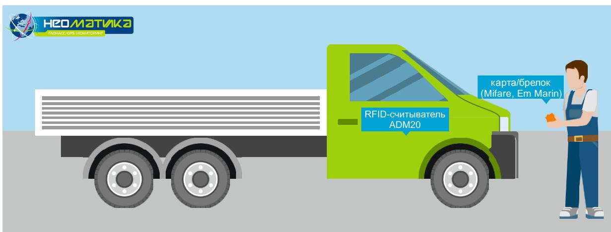
Рис.3. RFID-система может использоваться в целях повышения дисциплины труда посредством учета рабочего времени водителей, а также для осуществления дополнительных противоугонных мер
