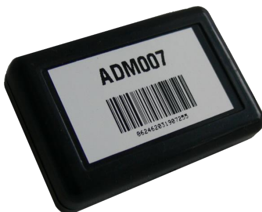
Figura 1 - El aspecto del rastreador (los cables no se muestran)
