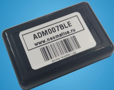
Ультракомпактный GPS/GLONASS трекер
